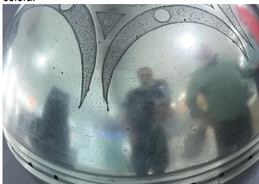
Poros en toda la superficie, evidencia de fundición de aluminio en molde de arena.
