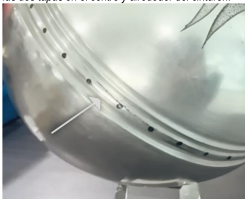
Marca central en la imagen del chip, probablemente marca dejada por la manipulación del torno, junto a perforaciones rellenas de cobre.
